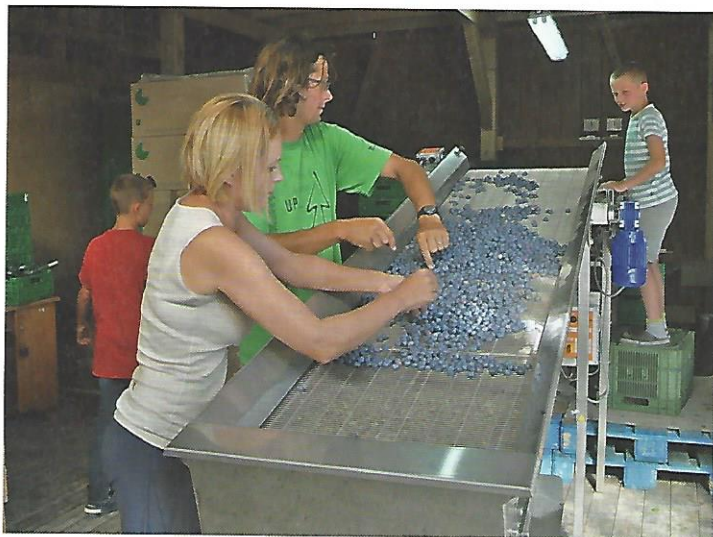
Auf dem Förderband der Abfüllanlage werden die Beeren kontrolliert, bevor sie in Schalen abgefüllt werden.
